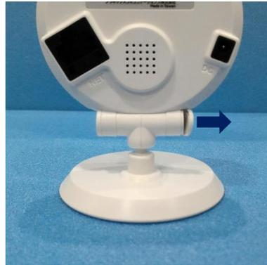
②プラスドライバーでねじを回し、可動部の固さを調整します。
